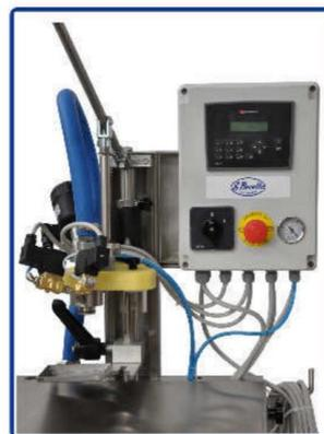
È una macchina riempitrice semiautomatica per Bag in Box da 2 litri a 20 litri. Riempie prodotti liquidi e semidensivi di tipo alimentare o di altra natura (es. vino ed olio fino a un massimo di viscosità di 300 cps). E' possibile realizzare un riempimento a caldo fino alla temperatura di 50°C con una pompa da 80 lt/min. Il dosaggio avviene con contalitri elettronico.
